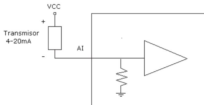
**NOTA:** La impedancia de entrada de cada entrada analógica es de 120 ohm por lo que la caída máxima de tensión (a 20mA) es de 2.4V.
