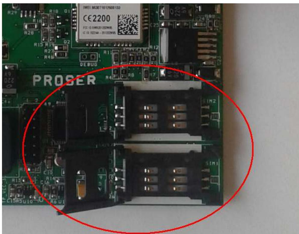
**NOTA:** Al insertar las tarjetas SIM, recordar que el equipo debe estar apagado.
